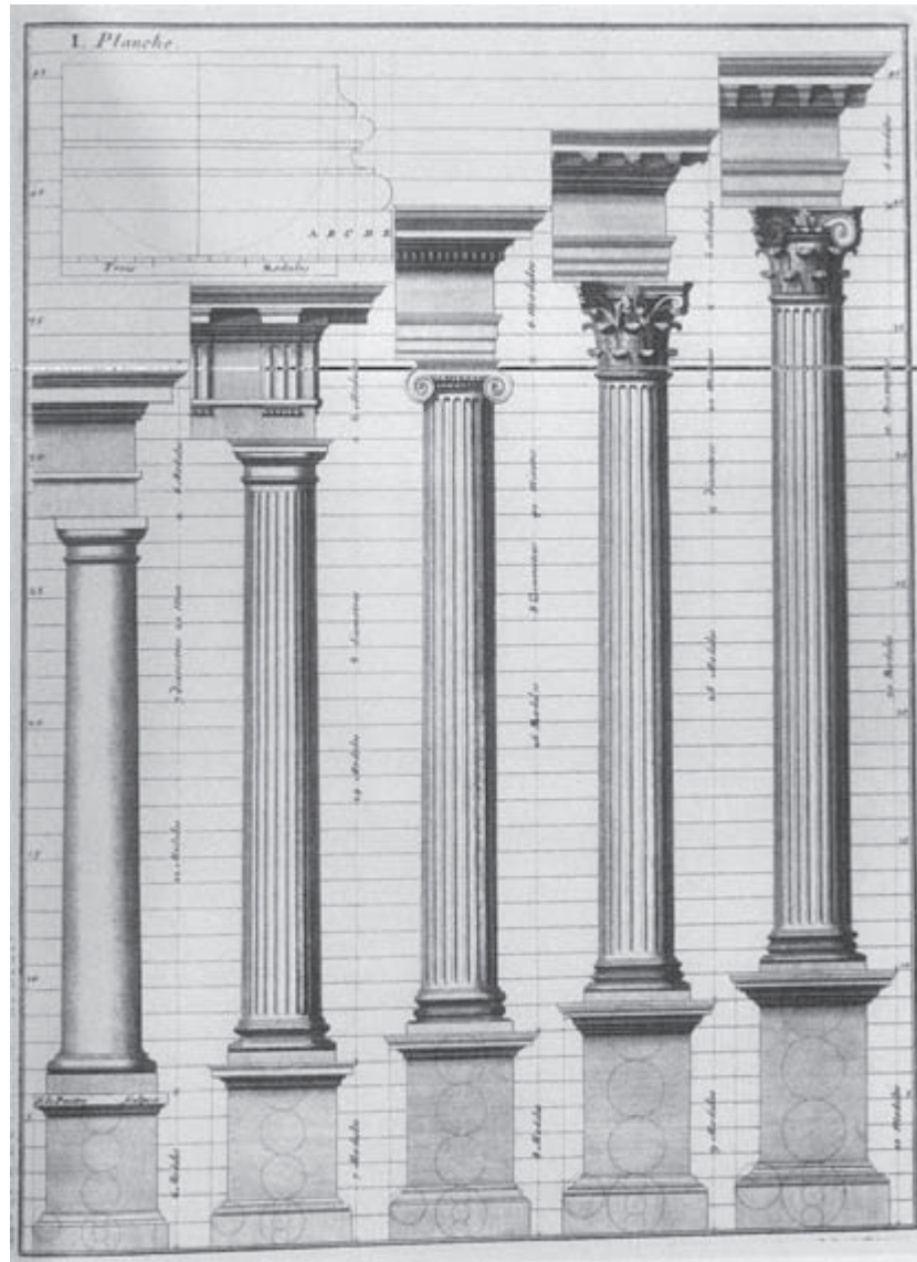
Figure 1.5 Comparative diagram of classical architectural orders, from Claude Perrault, Ordonnance des cinq espèces de colonnes . . . (Paris, 1683).
